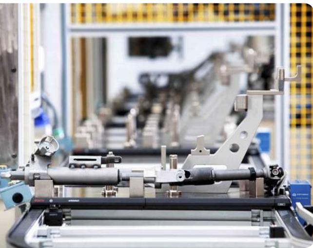
Línea de Montaje Columna Eléctrica /
