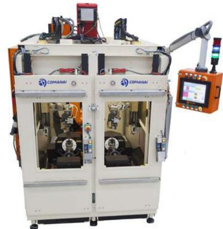
**Máquina de Soldadura BAD Robotizada**
